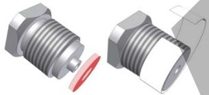
En ambos casos, la fuerza de apriete debe de aplicarse mediante dos llaves, una sobre los 2 planos de la conexión a proceso del instrumento y la otra sobre la toma de presión. Cuando se presurice el sistema por primera vez se debe verificar la estanqueidad de la conexión. Verificar la correcta instalación del instrumento así como la correcta fijación de los accesorios.
